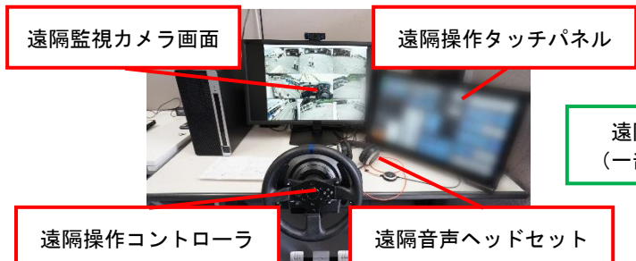
自動運転バス(上)と「遠隔監視・操作システム」(左)
