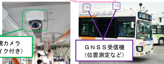
自動運転バス(上)と「遠隔監視・操作システム」(左)
